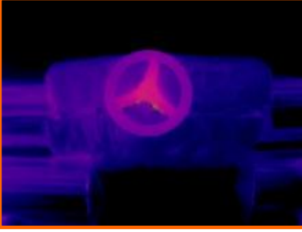
İzocam Vana Ceketleri uygulamasından sonra yalıtımlı termal kamera görüntüsü
